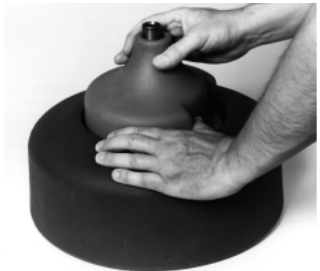
Figure 15 – Dépose du tambour interne
