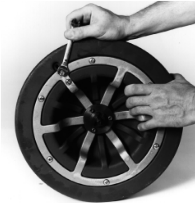
Figure 12 – Desserrage de l'étrier de câble
