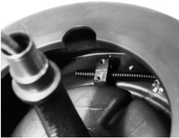
Figure 16 – Position du nouveau câble dans le collier
