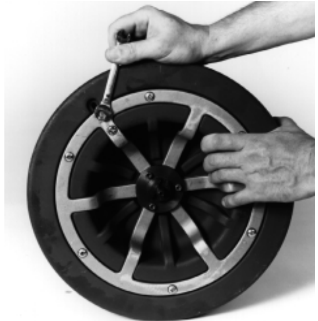
Figura 12 – Suelte la brida del cable
