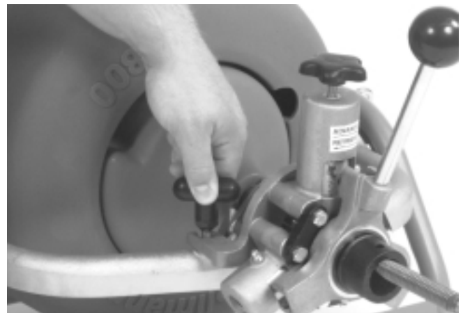
Figura 4 – Montaje de la autoalimentación al bastidor
