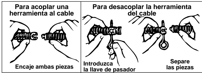
Figura 6 – Modo de acoplar y desacoplar herramientas
