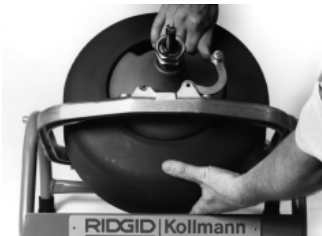
Figure 2 – Alignement du tambour sur la boîte d'engrenages
