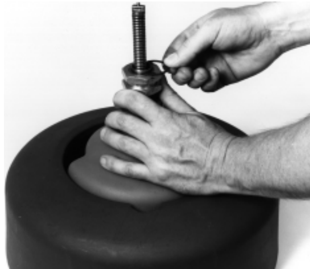
Figure 17 – Remontage du tambour interne, du collier avant et des cerclips.
