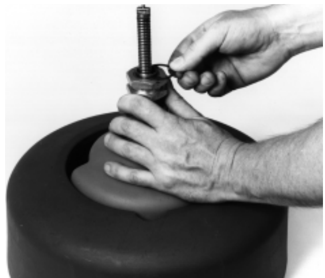
Figura 17 – Vuelva a colocar el tambor interno, la brida delantera y los clips en E
