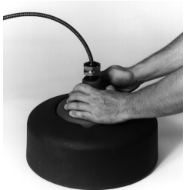
Figura 13 – Extracción del extremo final del cable
