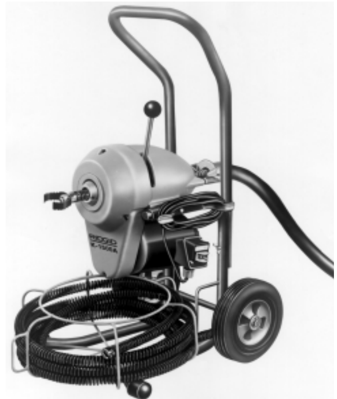
Figure 11 – Stockage des câbles sur les modèles à cadre type 'A'
