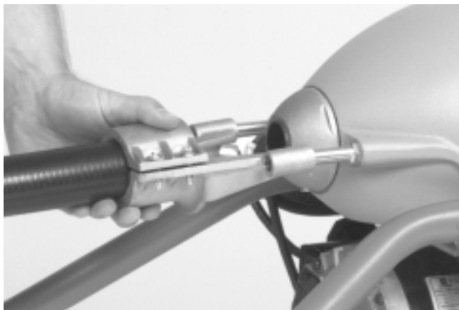
Figure 3 – Montage du guide-câble arrière
