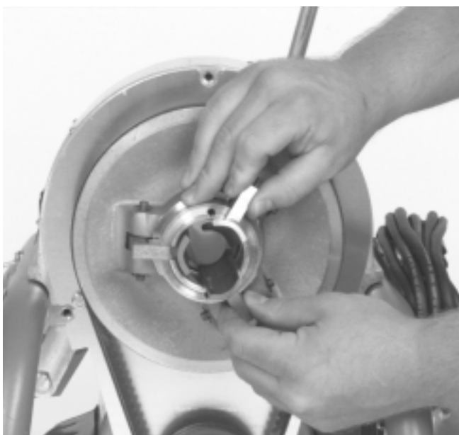
Figura 13 – Recambio de las mordazas del embrague
