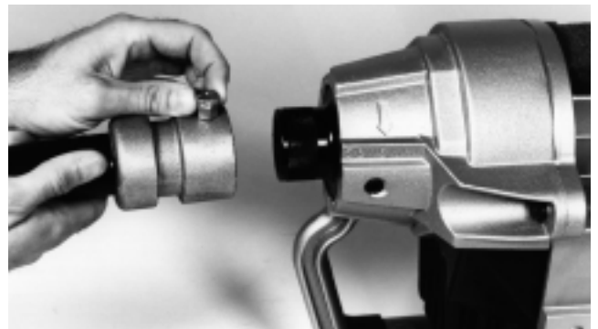
Figure 4 – Montage du guide-câble arrière
