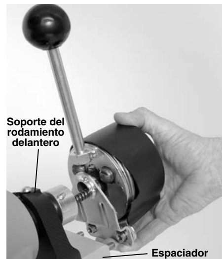
Figura 4 – Montaje del AUTOFEED a la armazón
