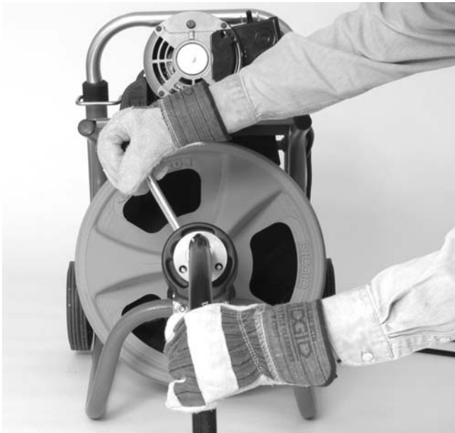
Figure 15 – Utilisation de l'appareil avec tuyau de guidage
