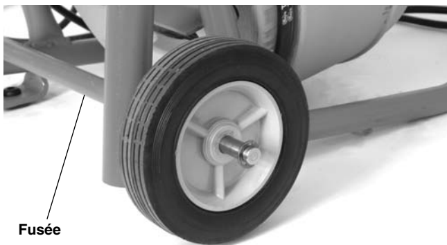
Figure 2 – Montage des roues
