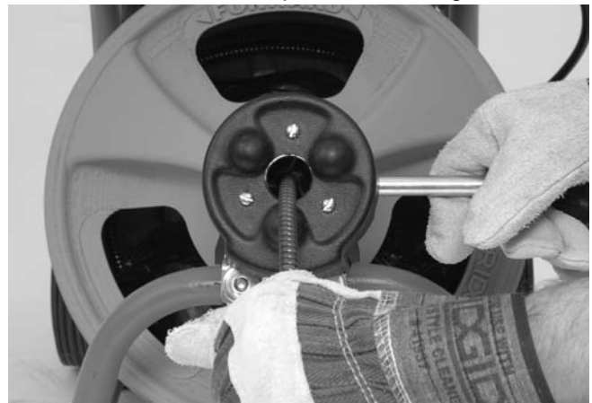
Figura 14 – AUTOFEED en posición para retraer el cable
