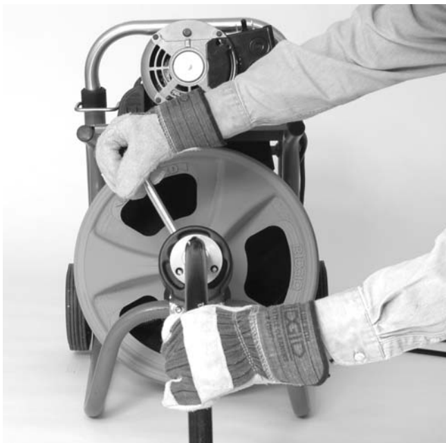
Figura 15 – Empleo de una limpiadora con manguera-guía delantera
